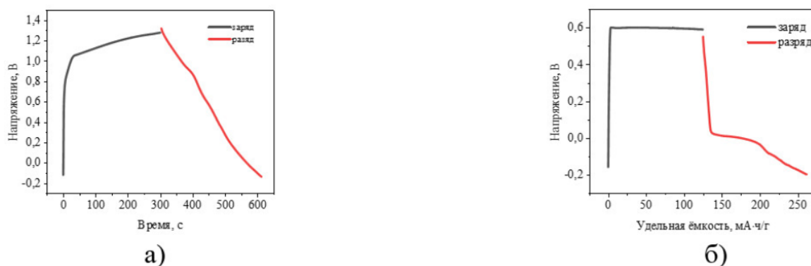
Рис. 1. Зарядно-разрядные кривые положительного электрода \text{WO}_3 : а — U(t) ; б — U(q)
